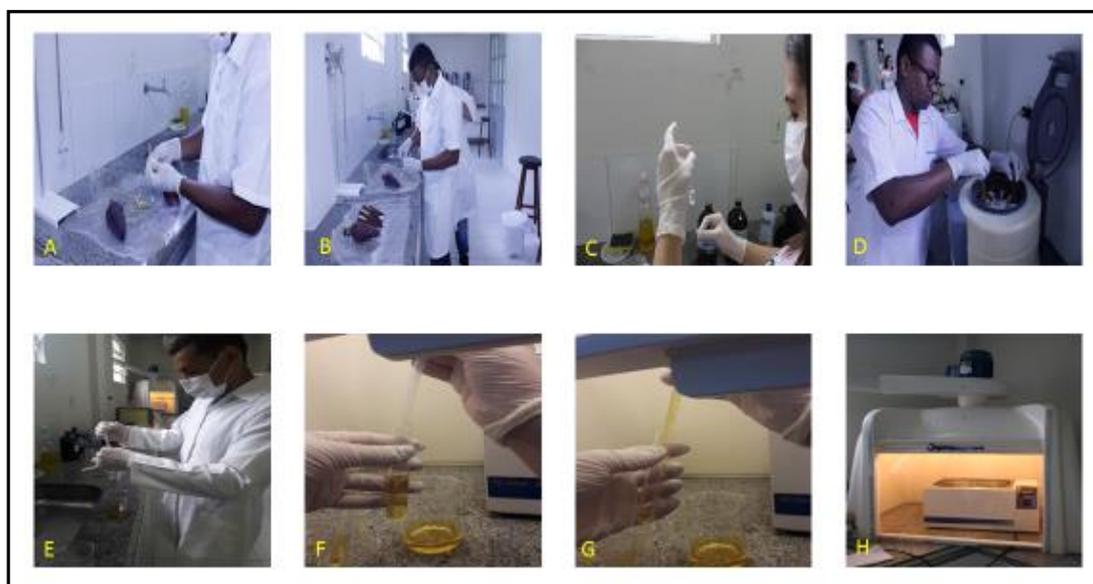
**Figura 3.** A e B) Retirada do material (tecas, estames, botões, etc.); C) colocando 1 ml de ácido acético glacial; D) Em seguida foi colocado na centrífuga; E) Desprezando o sobrenadante; F) Acrescentou-se 1 ml da mistura de acetólise; G) Acrescentou-se 5 ml de acetólise; H) foi aquecido em banho-maria, dentro da capela. **Fonte:** NUPAM
