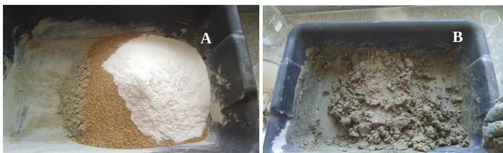
FIGURA 2. Elaboração das placas de argamassa. A) mistura dos materiais, B) amassamento da mistura, C) moldagem da placa e D) placas prontas e fixadas.
