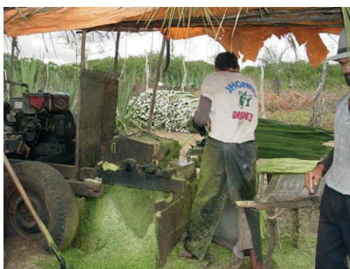
Figura 9 - Bagaço (material esverdeado na base da figura) gerado do processo de desfibramento por pequenos agricultores
