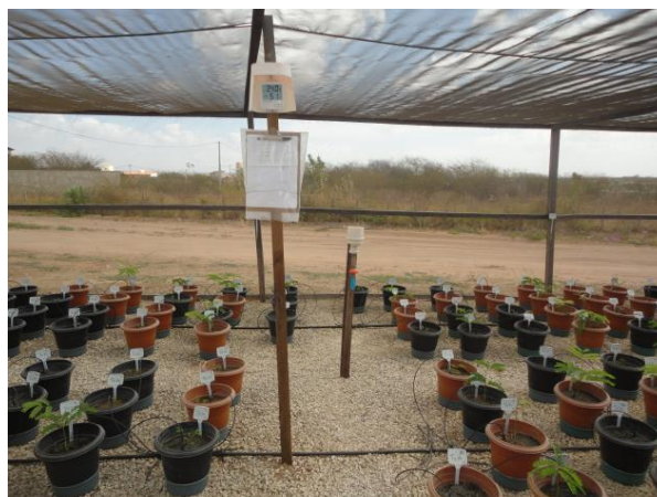
Figura 1. Termohigrômetro e pluviômetro para aferição de variáveis climatológicas instalados no local do experimento, no período de agosto/2016 a fevereiro/2017.
