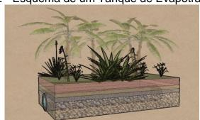
Figura 2 - Esquema de um Tanque de Evapotranspiração.
