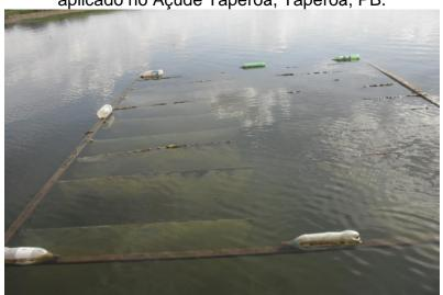
Figura 25 - Estruturas flutuantes, utilizando plástico como fixador de biofilme, aplicado no Açude Taperoá, Taperoá, PB.
