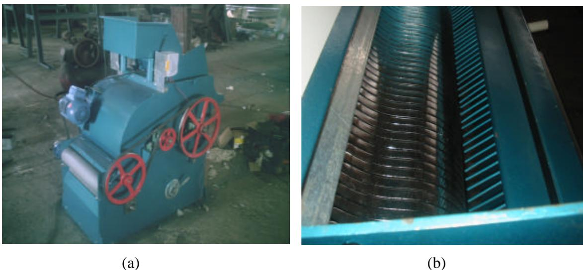
Figura 4.1. Foto do descaroçador de 20 serras (a) com detalhe do dispositivo para regulagem da quantidade de línter (b).
