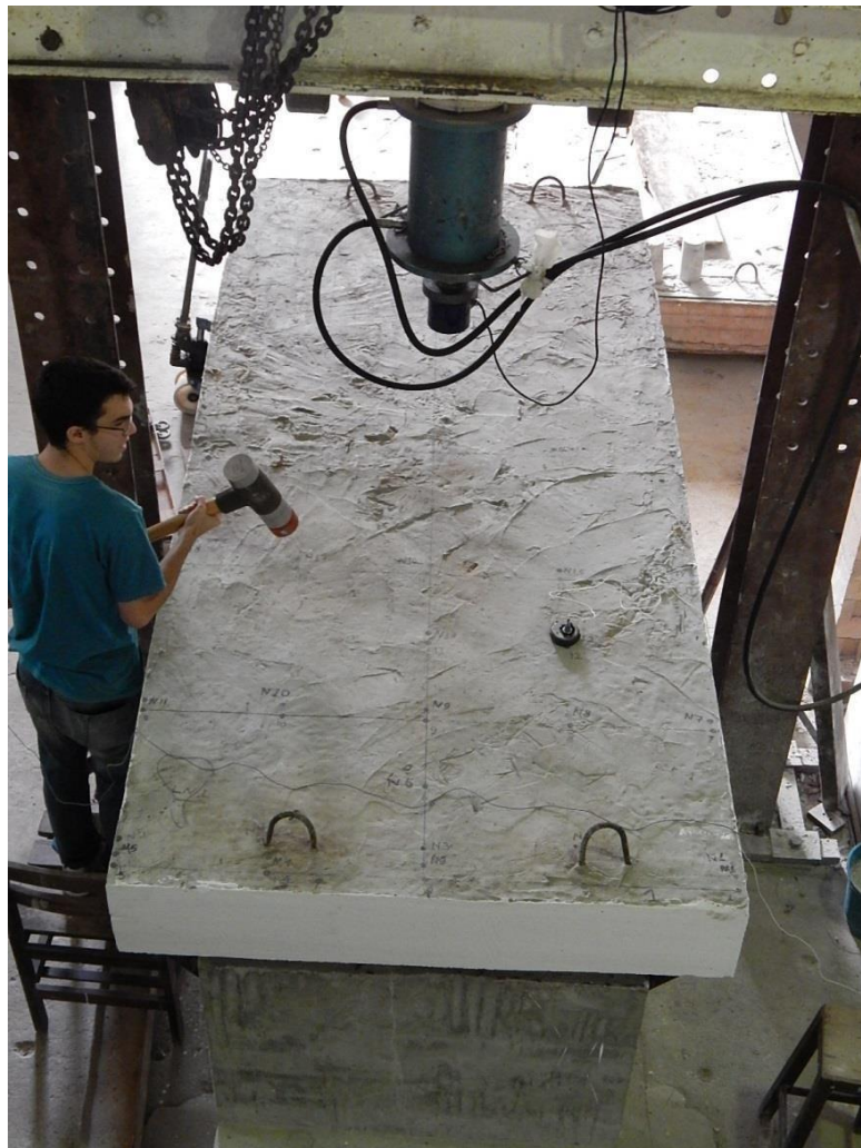
Figura 27 – Teste modal na laje nervurada 1
