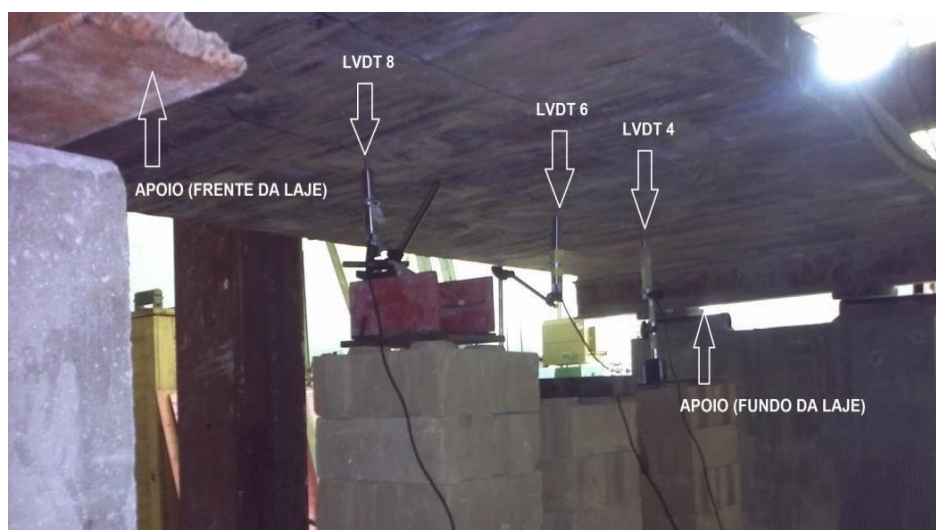
Figura 19 - Posicionamento dos LVDT's da laje maciça 1
