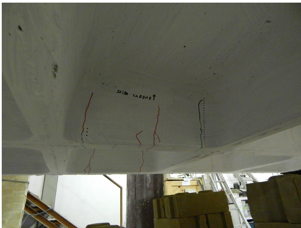
Figura 99 - Fissuras (em vermelho) surgidas após a aplicação da carga de 28kN – LN1. Foto da laje vista de baixo.
