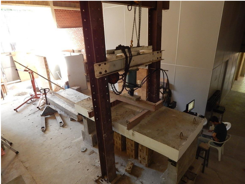
Figura 25 - Sistema de aplicação de carga na laje nervurada 1.
