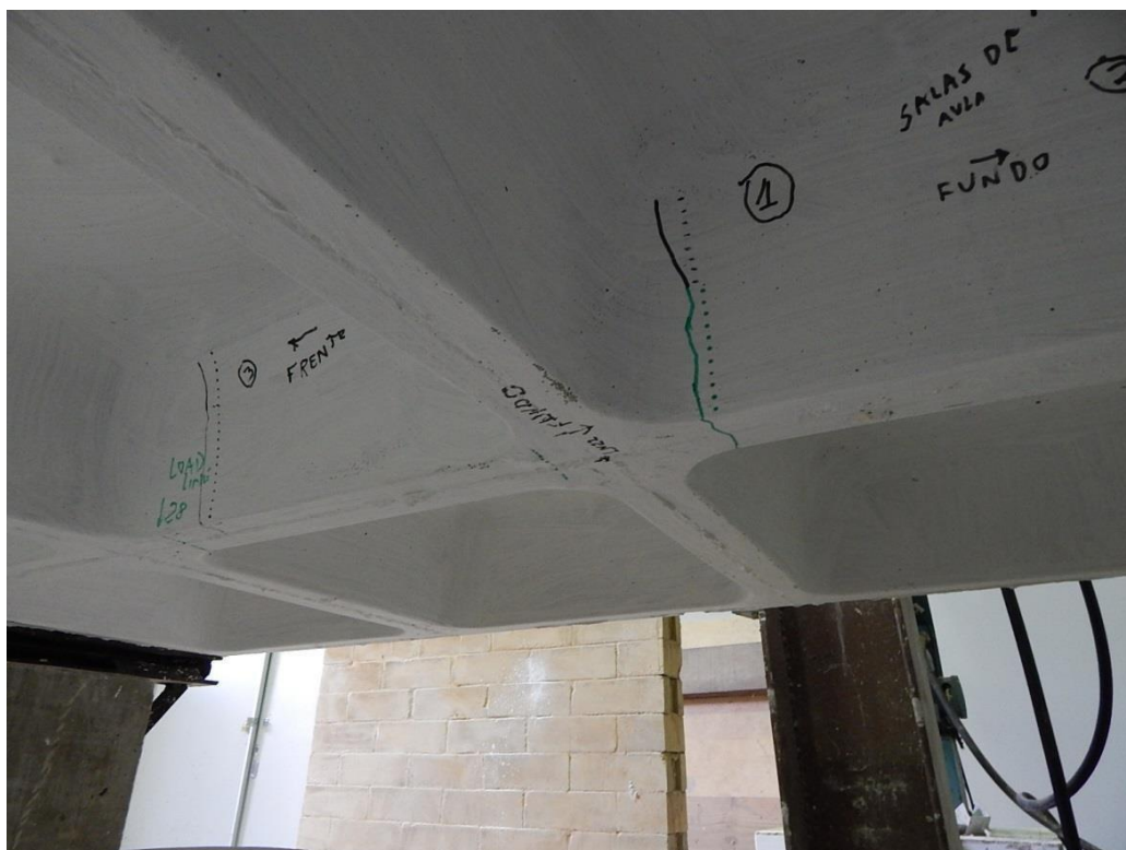
Figura 98 - Fissuras (em preto) surgidas após a aplicação da carga de 22kN – LN1. Foto da laje vista de baixo.
