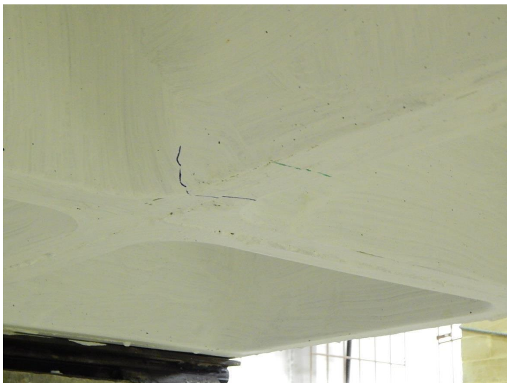
Figura 97 - Fissura (em azul) surgida após a aplicação da carga de 16kN – LN1. Foto da laje vista de baixo.
