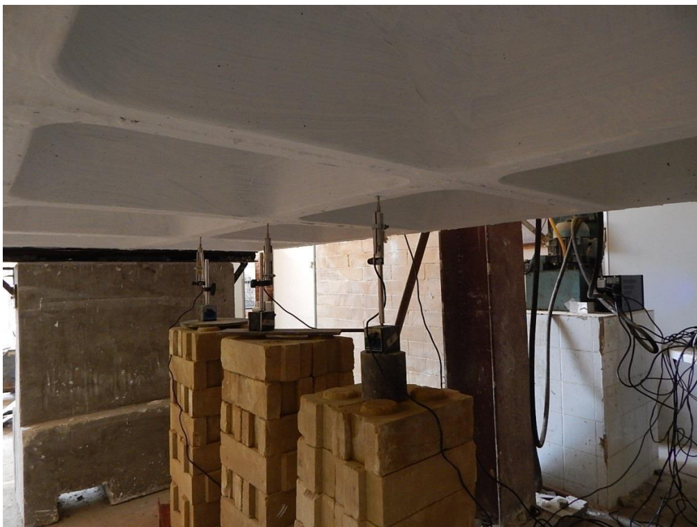
Figura 26 - Posicionamento dos LVDT's da laje nervurada 1
