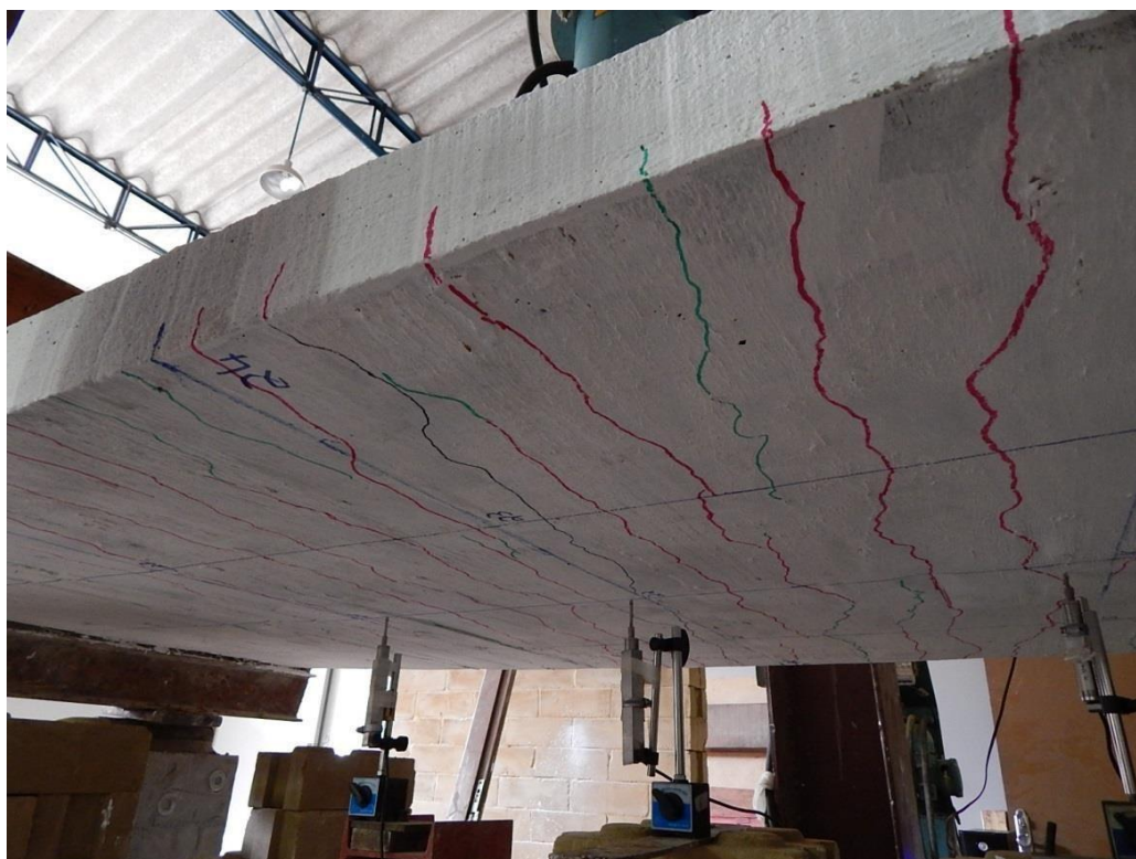
Figura 66 - Fissuras (em verde) surgidas após a aplicação da carga de 22KN. Foto da laje vista de baixo.
