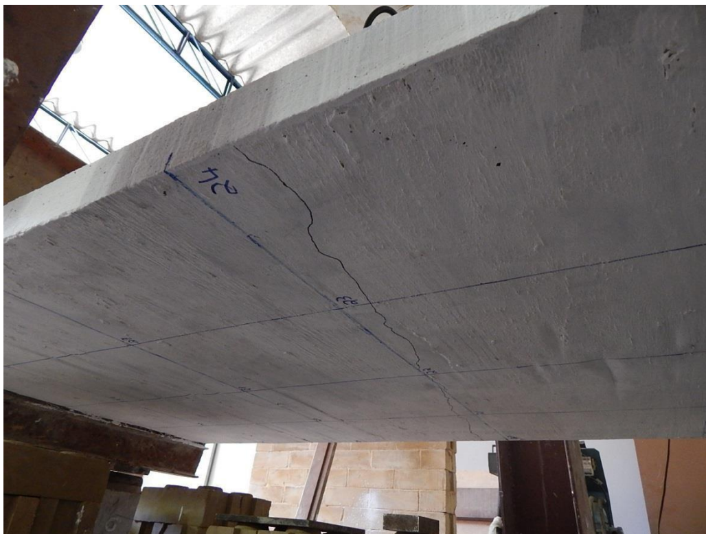
Figura 64 – Fissuras (em preto) surgidas após a aplicação da carga de 8KN. Foto da laje vista de baixo.
