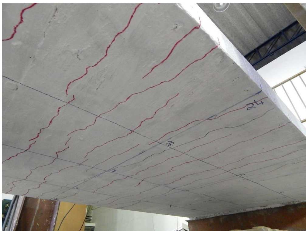
Figura 65 - Fissuras (em vermelho) surgidas após a aplicação da carga de 16KN. Foto da laje vista de baixo.
