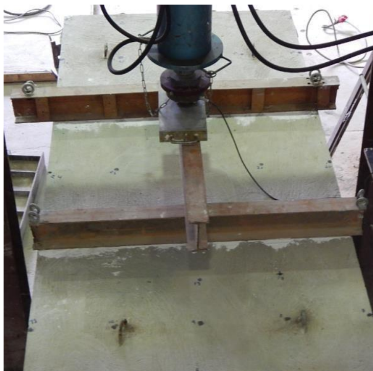
Figura 18 - Sistema de aplicação de carga na laje.
