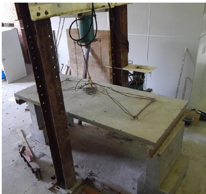
Figura 14 - Laje maciça sobre os apoios após ter sido içada com auxílio de cabos de aço.
