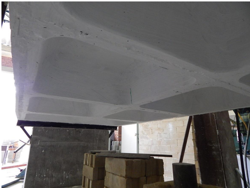
Figura 96 - Fissura (em verde) surgida após a aplicação da carga de 8kN – LN1. Foto da laje vista de baixo.
