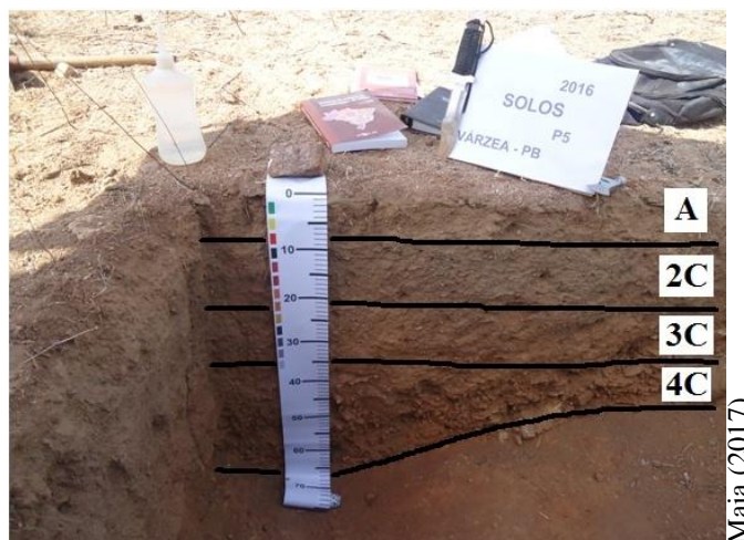
Figura 16. Perfil de um NEOSSOLO FLUVICO Ta Eutrófico típico, localizado na área PJ, Fazenda Cachoeira de São Porfírio, em Várzea, PB.
