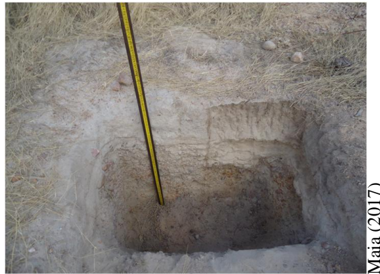
Figura 5. Determinação da profundidade efetiva do solo na área PN.
