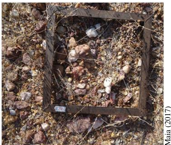
Figura 8. Determinação de pedregosidade na área CAH.
