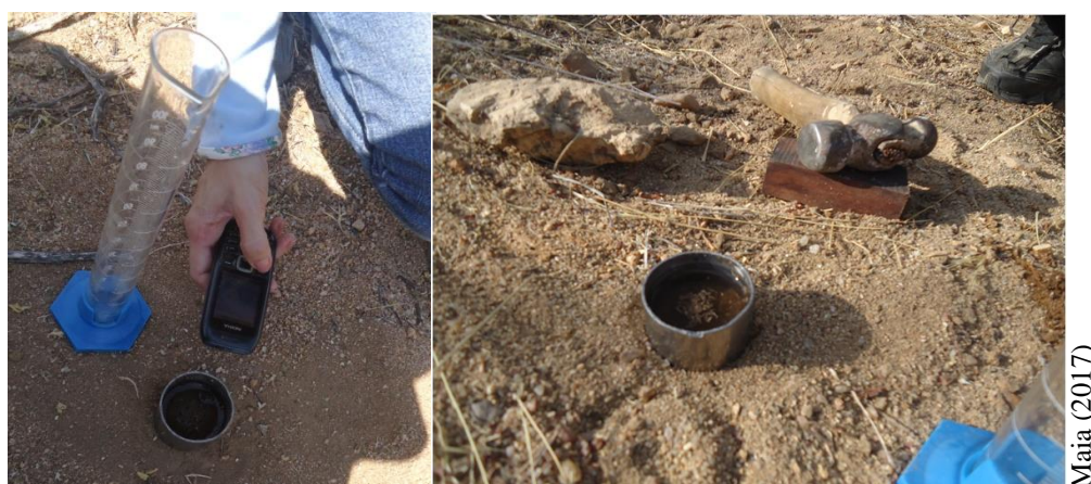
Figura 6. Determinação da permeabilidade do solo na área PJ.
