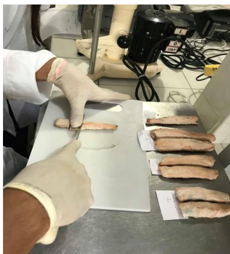
Figura 8. Fazendo as amostra para força de cisalhamento
