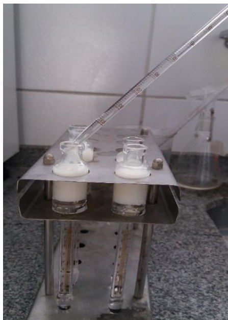
Figura 1: Análise e gordura pelo método de GERBER
