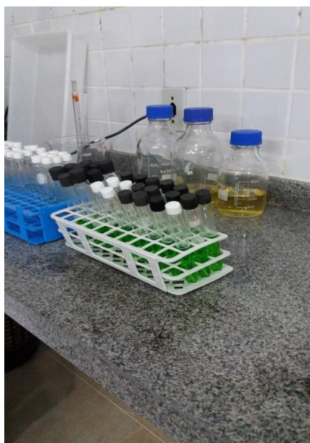
Figura 3: Tubos com Caldo VB para análise de Coliformes Totais
