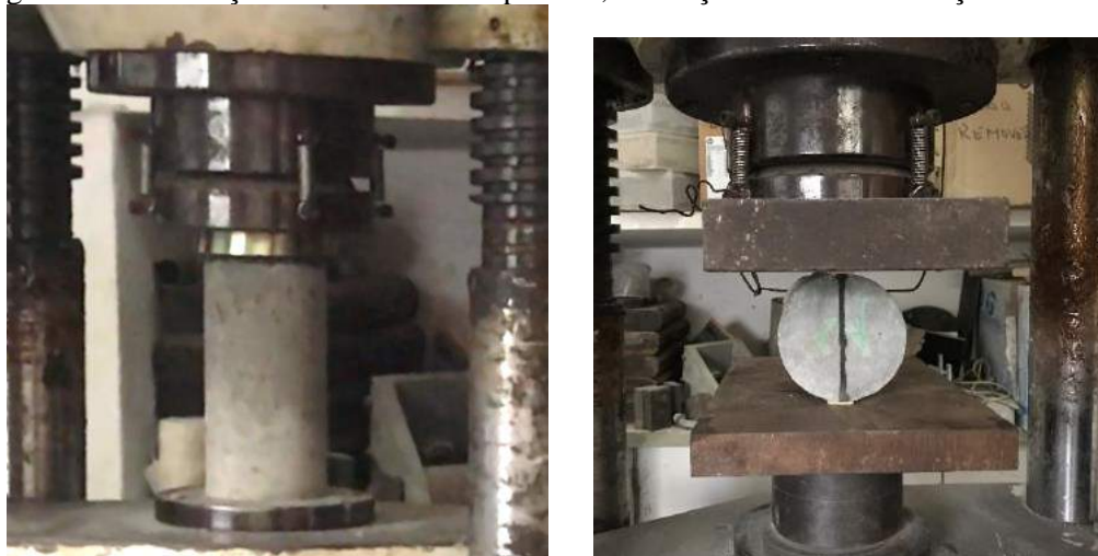
Figura 4. 2 - Execução do ensaio de compressão; Execução do ensaio de tração indireta.
