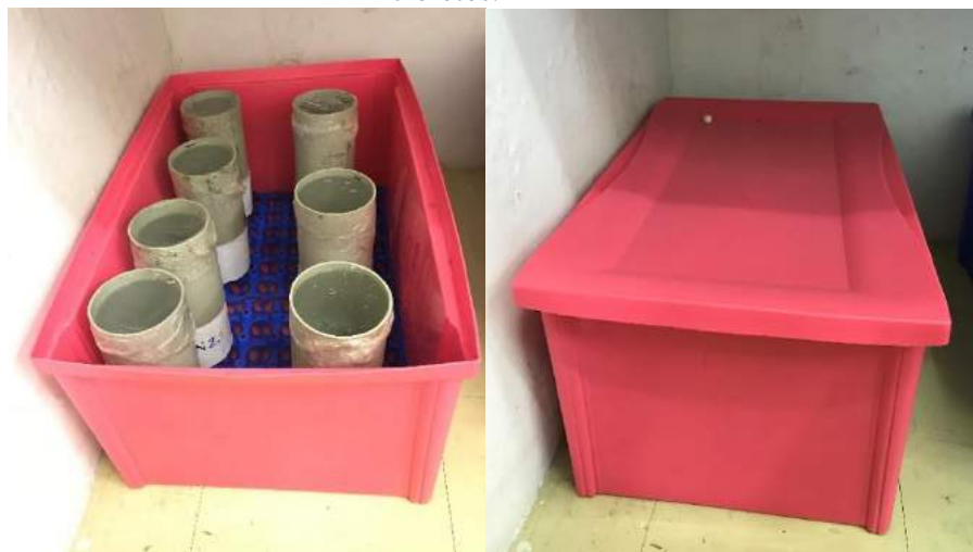
Figura 4. 5 – Condições de exposição dos corpos de prova para o ensaio de difusão unidirecional de cloretos.
