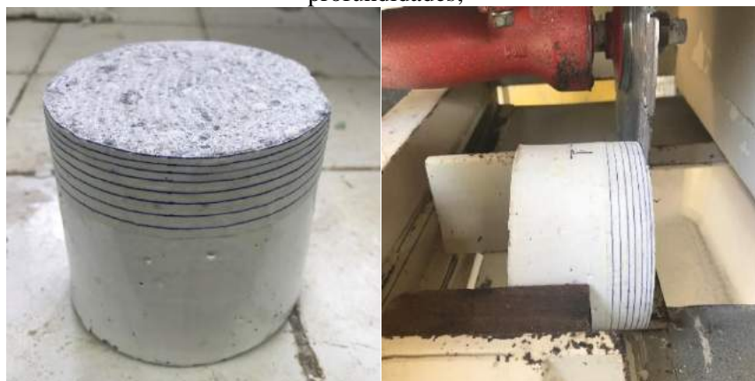
Figura 4. 6 – Marcação das camadas a serem cortadas; Extração das amostras nas diferentes profundidades;
