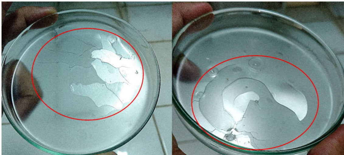
Figura 13 - Biofilme obtido a partir de uma solução filmogênica de amido de mandioca com a esquerda o [BA][Leu] 1,0%(m/m) e a direita [BA][Leu] 1,0%(m/m) e Glicerol 0,5% (m/m), através do método casting .
