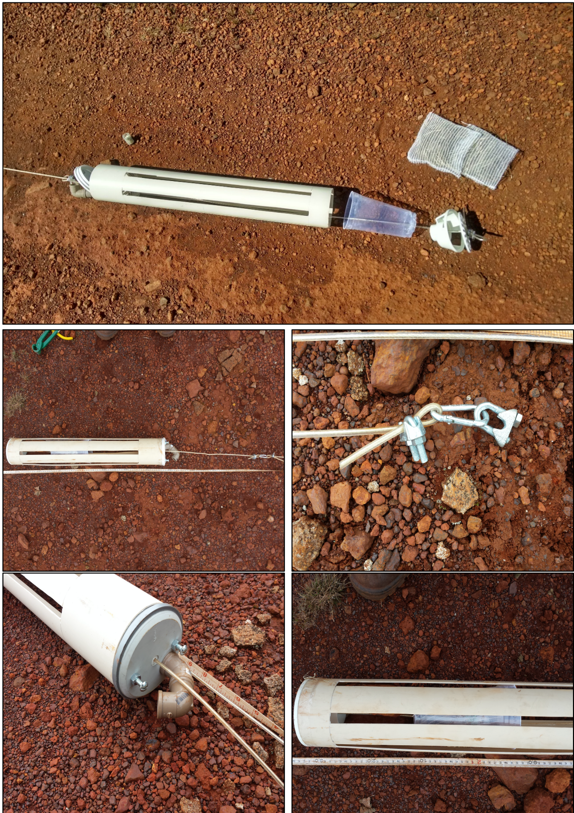
Figura 18 – Armadilha para coleta no HSS, através dos furos de sondagem, no Quadrilátero Ferrífero, MG.
