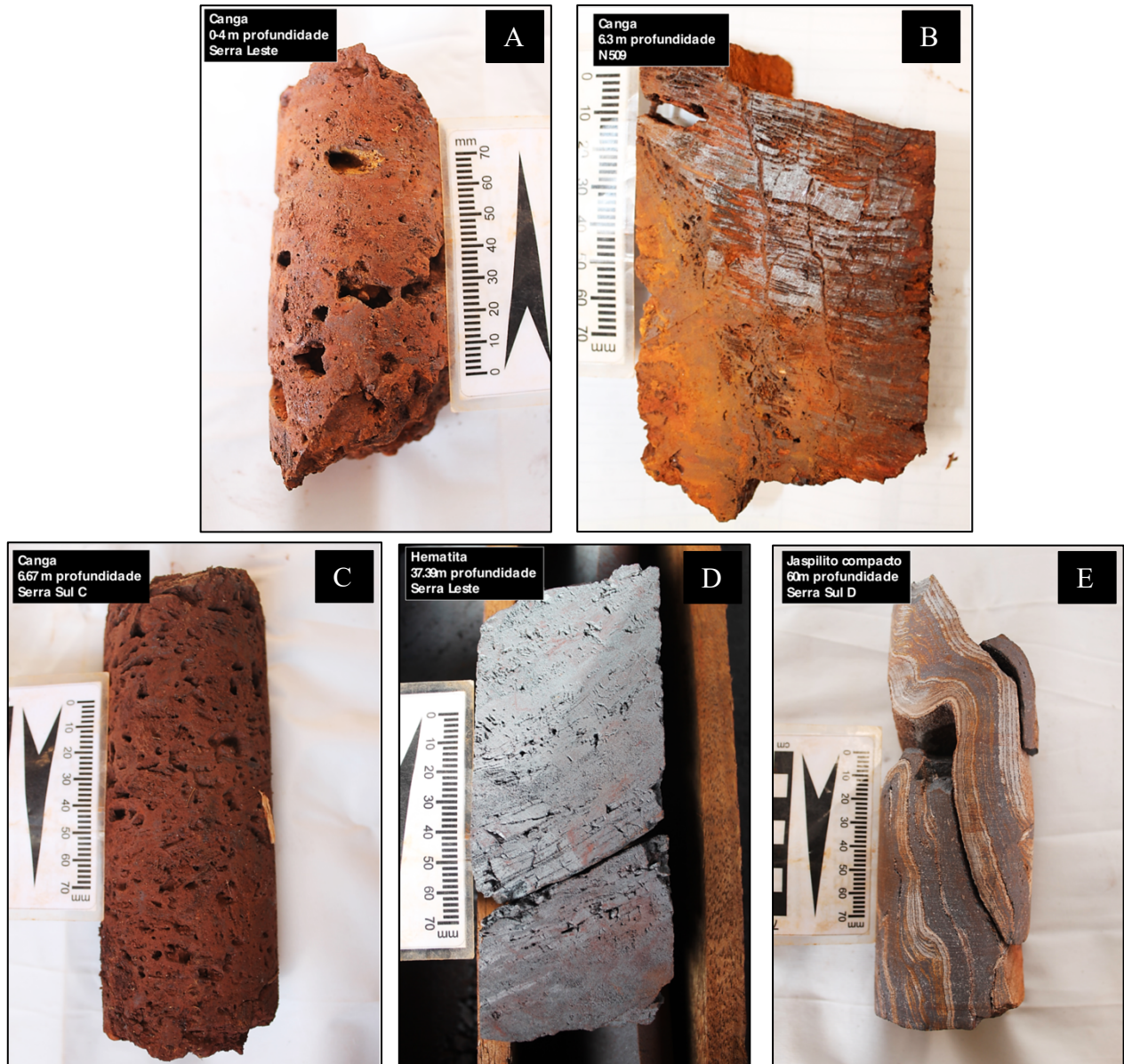
Figura 2 – Testemunhos de furos de sondagem em litologia de minério de ferro, na região de Carajás, Pará. Junto com o Quadrilátero Ferrífero elas centralizam mais de 90% das jazidas e minério de ferro no Brasil. (a) – (d) é possível observar os canalículos do HSS presente na canga entre 0 – 6.7 metros de profundidade, (e) e (f) HSS formado por fissuras nas rocha abaixo do regolito a 37,39 metros e 60 metros de profundidade. Fotos cedidas pela empresa Vale S.A.
