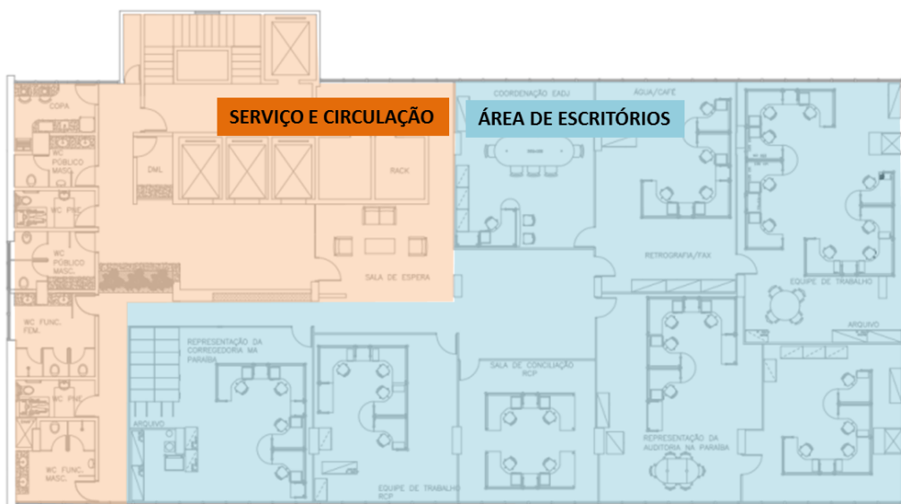
Figura 38: Setorização dos pavimentos do Edifício Norte/Sul .
