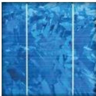
Figura 16 - Modelo de célula fotovoltaica feita de silício multicristalino Fonte: TIGGEMANN (2015).
