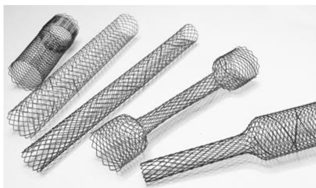
Figura 2.2 -Dispositivos auto expansivos com memória de forma (Marston e Razavi, 2019).
