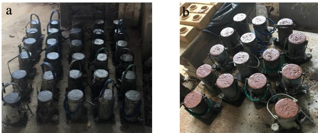
**Figura 9.** (a) Corpos de prova de concreto à base de cimento portland; (b) Corpos de prova à base de MAA.
