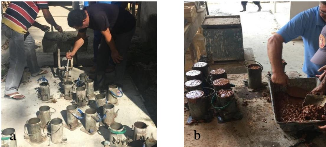
**Figura 8.** (a) Moldagem dos corpos de prova à base de cimento portland; (b) Moldagem dos corpos de prova à base de MAA.
