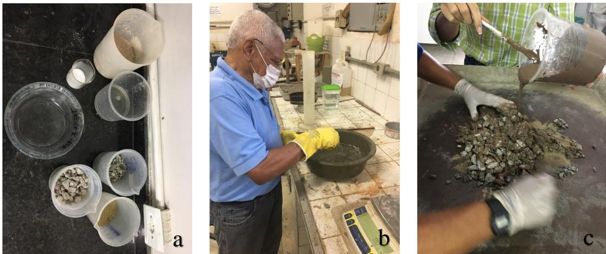
**Figura 7.** (a) Separação e pesagem dos precursores para a pasta de MAA; (b) mistura do NaOH com água ocasionando uma reação exotérmica; (c) mistura da pasta de MAA com os agregados.
