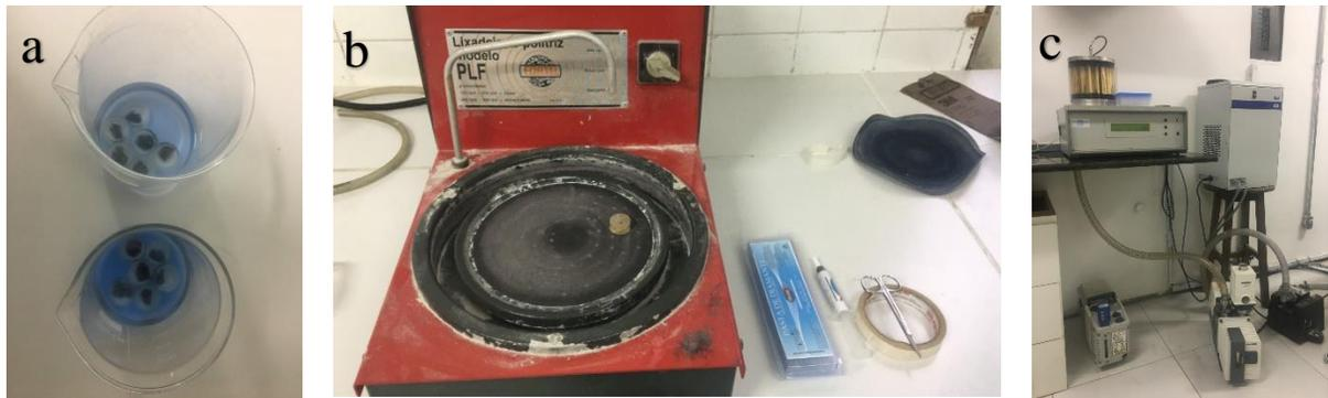
**Figura 13.** (a) Amostras imersas em álcool isopropílico para o banho de ultrassom; (b) Máquina de polimento com pasta diamantada; (c) Processo de metalização das amostras.
