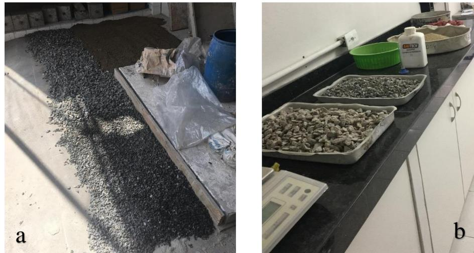
**Figura 5.** (a) Tratamento e separação dos agregados; (b) Pesagem e preparação dos agregados após secagem em estufa.
