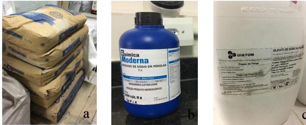
**Figura 4.** (a) Sacas de Metacaulim cedidos pela Metacaulim do Brasil e estocados no almoxarifado do LABEME; (b) Hidróxido de Sódio em pérolas, da empresa Química Moderna; (c) Silicato de sódio da empresa Diatom S/A.
