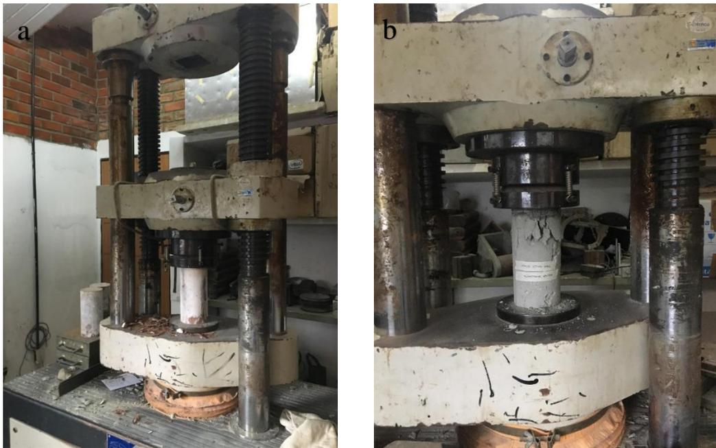
**Figura 14.** (a) Ensaio de resistência mecânica MAA; (b) Ensaio de resistência mecânica CP.
