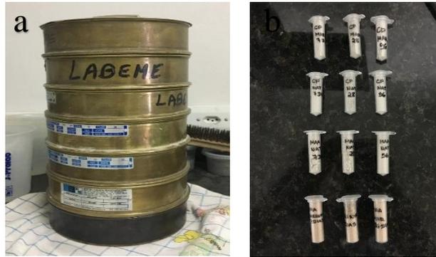
**Figura 11.** (a) Peneiras utilizadas na preparação das amostras; (b) Eppendorfs finalizados.
