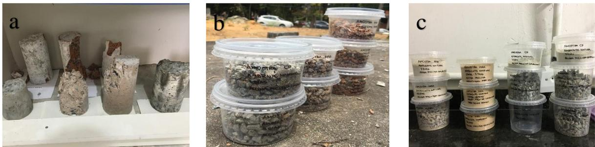
**Figura 10.** (a) Corpos de prova rompidos; (b) Amostras fragmentadas manualmente; (c) Parte das amostras já maceradas após a moagem no moinho de bolas.
