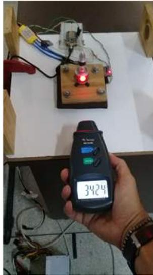
**Figura 5.1** - Medição da velocidade do motor em tempo de coleta. Fonte: O autor (2019)
