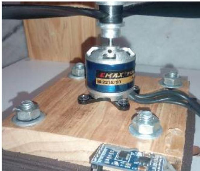
**Figura 3.3** - Detalhe do Motor BLDC usado na bancada. Fonte: O autor (2018)
