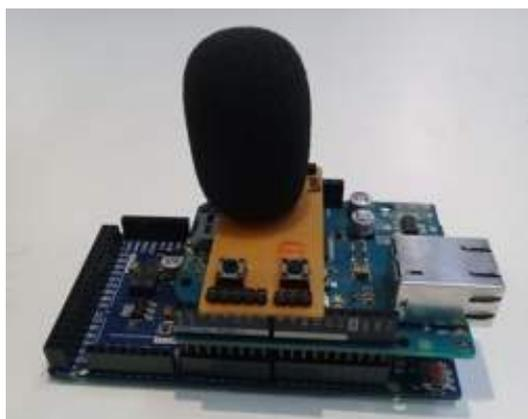
**Figura 3.4** - Plataforma Arduino com microfone embarcado. Fonte: Lima (2017)
