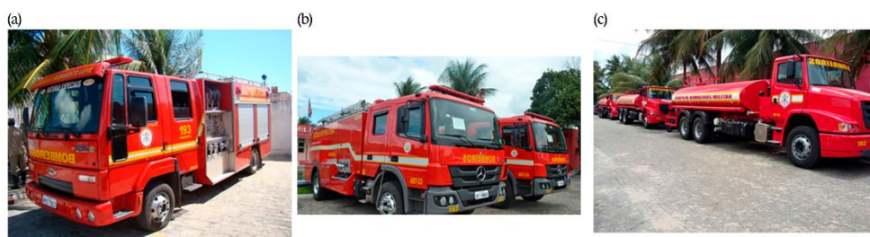
Figura 2. (a) Auto Bomba Tanque Leve (ABSL), (b) Auto Bomba Tanque (ABT) e (c) Auto Tanque (AT). Fonte: Acervo 1º BBM/CBMPB, 2020.
