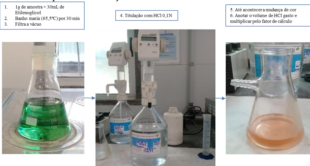
Figura 10 Procedimento para Determinação do CaO livre.
