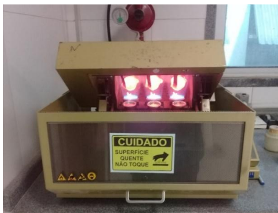
Figura 8 Máquina de fusão para confeccionar pérola fundida.
