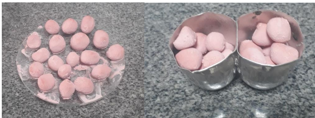
Figura 22 Nódulo de Farinha para a Clinquerização.
