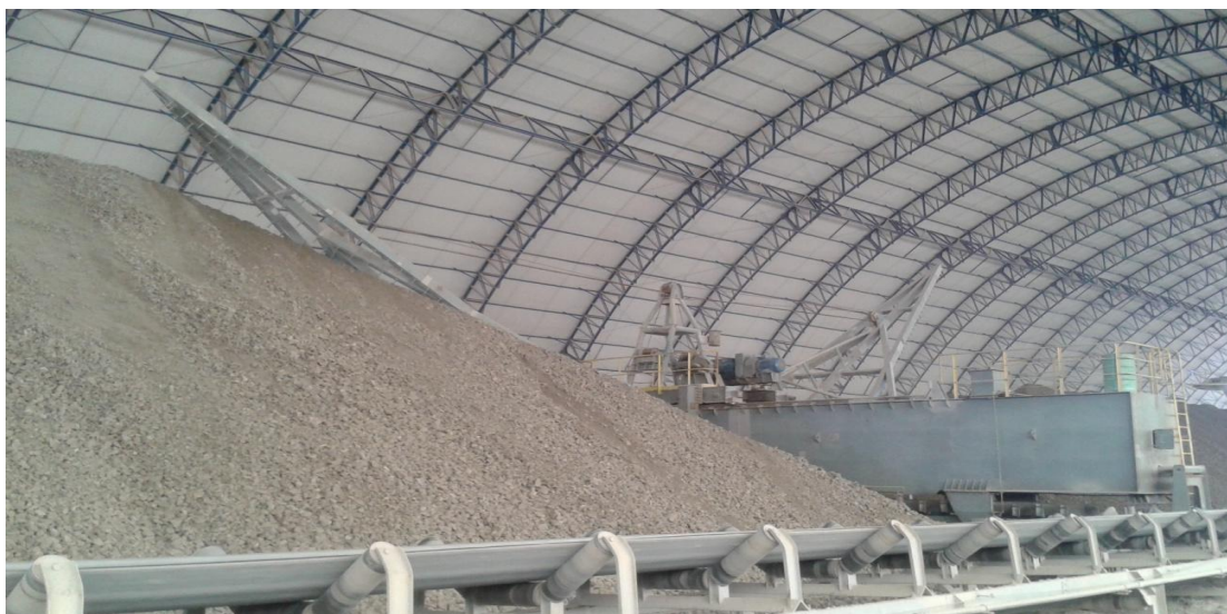
Figura 4 Retomadora de calcário.
