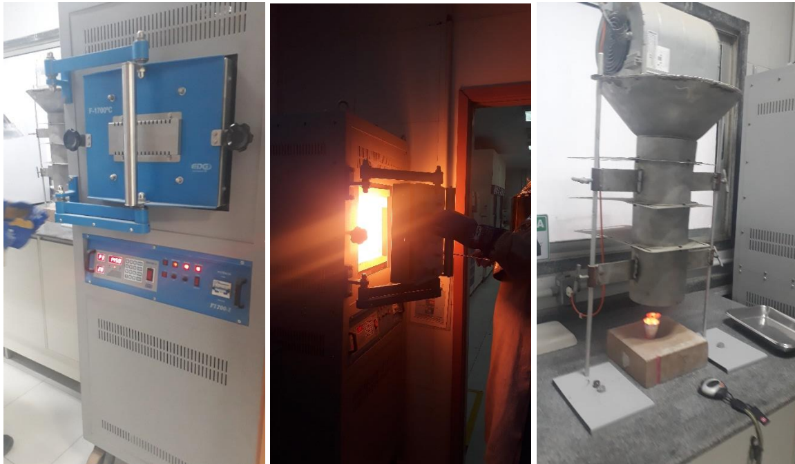
Figura 23 Mufla EDG e Resfriador de clínquer.
