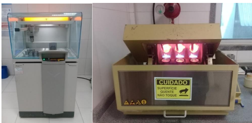
Figura 21 Equipamentos Utilizados para Análise Química: Axios – Cement - Max – Panalytical e Maquina de Fusão, respectivamente.
