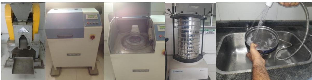
Figura 20 Equipamentos Utilizados para Preparação das Frações de Quartzo: Britador de Mandíbulas, Moinho de Anéis, Peneirador Mecânico e Peneiramento Manual, respectivamente.
