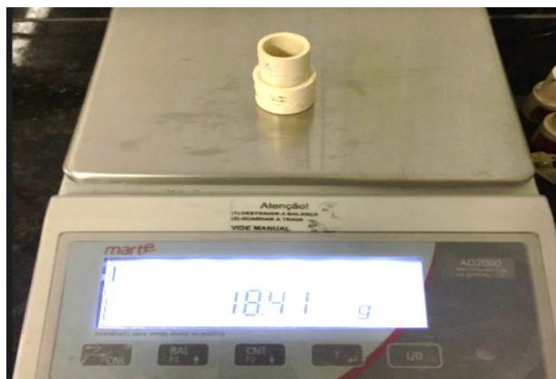
Figura 5 - 1ª pesagem – corpo de prova + vaselina.
