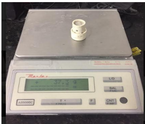
Figura 7 - 3ª pesagem – corpo de prova + cimento após 7 e 28 dias.
