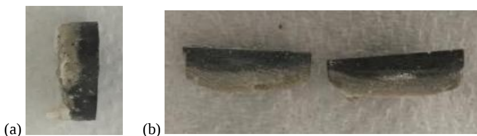
Figura 15 - (a) Topo da amostra. (b) Topo da amostra cortado de forma que possa-se visualizar a parte que ficou em contato com a saliva e a parte sem contato com saliva.
