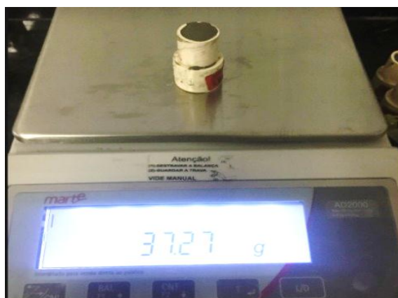
Figura 6 - 2ª pesagem – corpo de prova + cimento.
