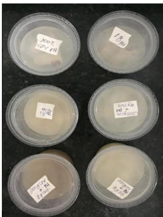
Figura 9 - Corpos de provas imersos em recipientes fechados contendo saliva artificial.
