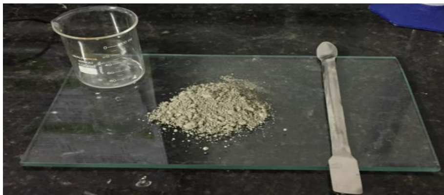
Figura 3 - Placa de vidro, com o pó e água destilada para a mistura do cimento, usando espátula metálica.
