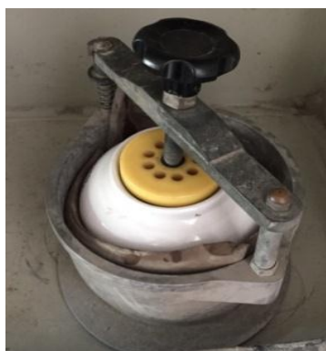
Figura 2 - Jarro em porcelana utilizado no moinho de bolas.
