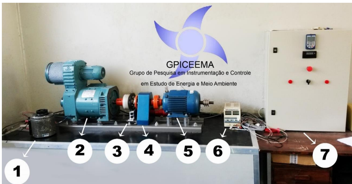
Figura 4.1 – Bancada para ensaios de torção em motores de indução trifásicos. Fonte: Autor.
