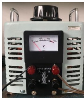
Figura 4.5- Varivolt utilizado para variação da carga aplicada. Fonte: Autor.
