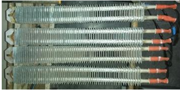
Figura 4.4 - Resistências aletadas acopladas à armadura. Fonte: Autor.
