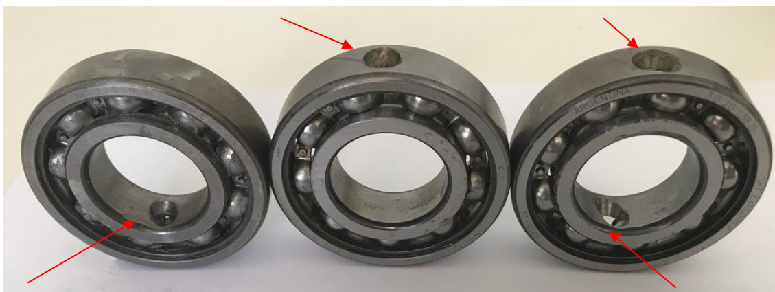
Figura 4.11 - Ilustra os furos nas pistas interna e externa (aproximadamente 5,8 mm de diâmetro). Fonte: Autor
