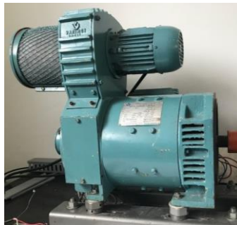
Figura 4.3 – Gerador de corrente contínua. Fonte: Autor.
