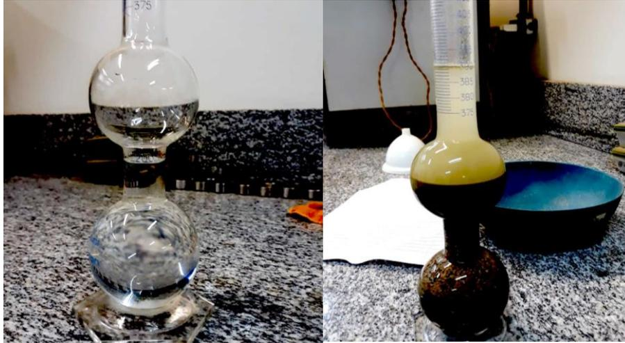
**Figura 9:** Determinação da massa específica por meio do Frasco *Chapman*.
