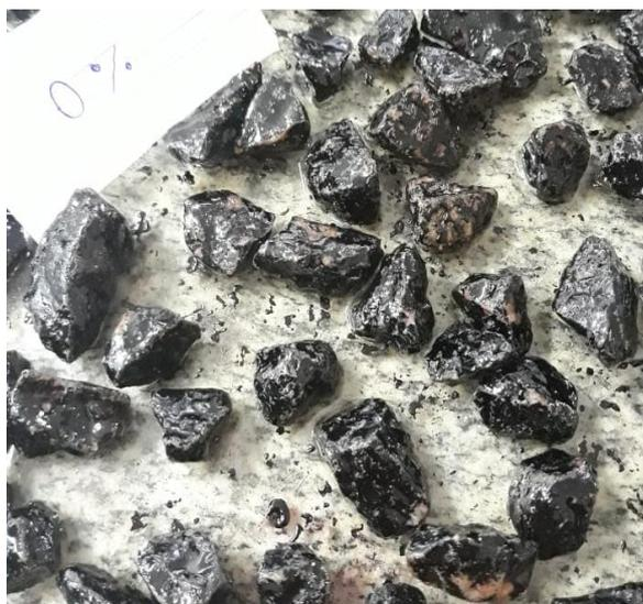
De acordo com a Figura 19 pode-se perceber que a adesividade foi insatisfatória, pois ocorreu descolamento da película de asfalto que recobria os agregados. A origem granítica dos agregados é um dos fatores que justificam esse comportamento, já que este tipo de agregado não possui uma boa afinidade ao asfalto.
