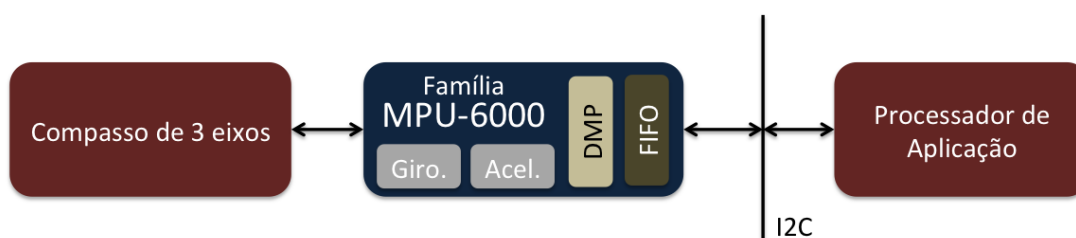
Figura 5.8 - Arquitetura do dispositivo MPU6050. Fonte: Dados produzidos pelo autor.
