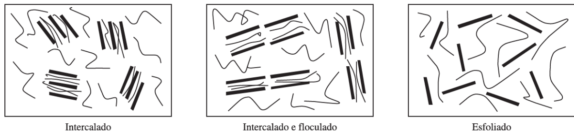
Figura 5– Ilustração de tipos de nanocompósitos poliméricos com argila como fase dispersa (Anadão et al. , 2011)
