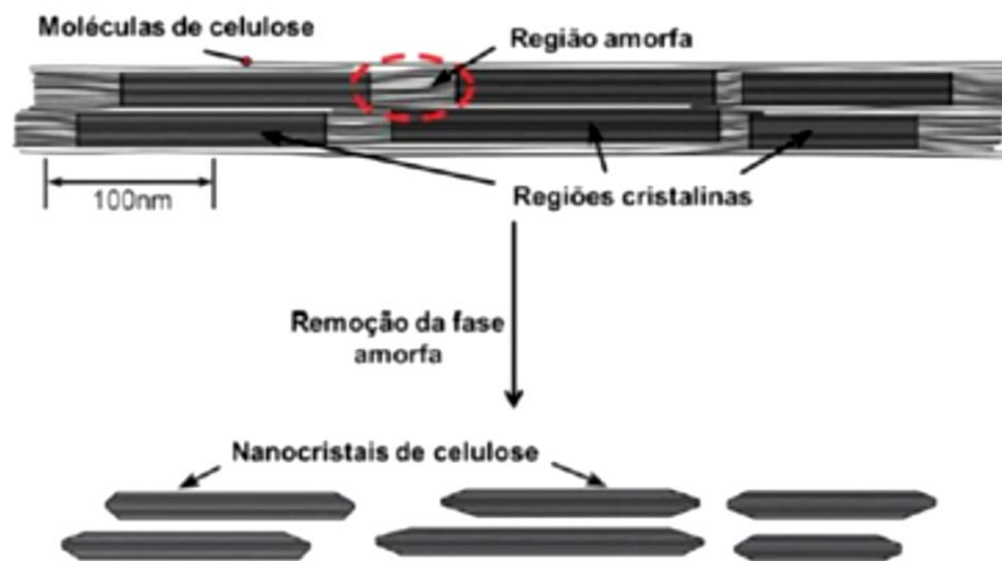
Figura 3 – Nanocristais de celulose unidos, compondo as microfibrilas (Silva& D’almeida, 2009).
