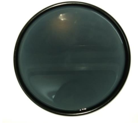
Figura 8 - Solução do nanocompósito na forma de teflon, antes da secagem na estufa, para obtenção do filme por evaporação do solvente.
