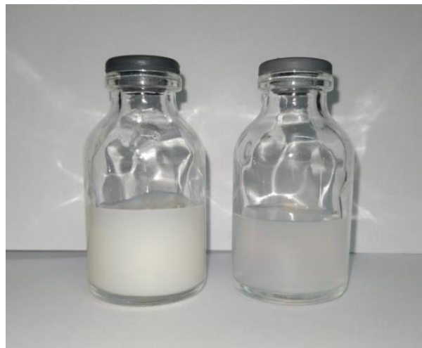
Figura 7 - Imagem do CNC após hidrólise ácida e após diluição para análise de AFM.
