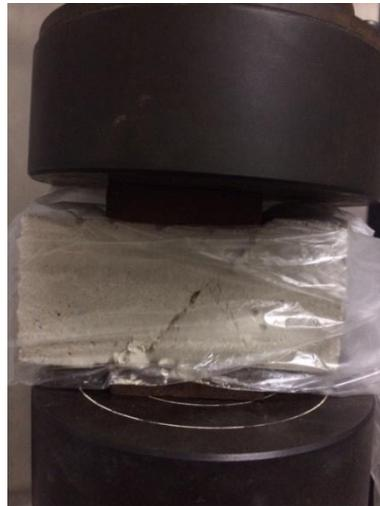
Para a determinação da resistência à compressão é utilizada a Equação 8.
