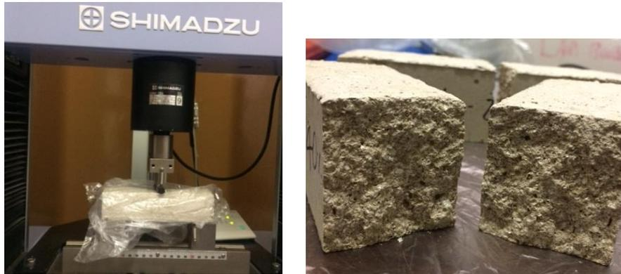
No caso da análise da resistência à compressão (Figura 23) foram utilizados seis corpos de provas de cada traço, assim como na resistência à tração na flexão, a velocidade de carregamento aplicada foi de  $50 \pm 10$  N/s.
