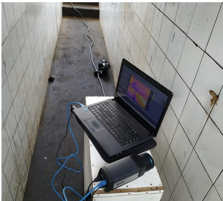
Figura 40- Câmera termográfica e computador instalados no momento das coletas
