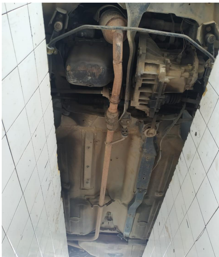
Figura 42- Sistema de Exaustão do Automóvel 01.
