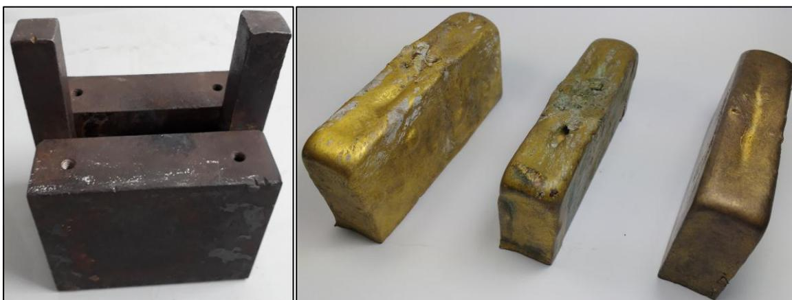
Figura 21 – Fotografia do molde e dos lingotes brutos de fusão.
