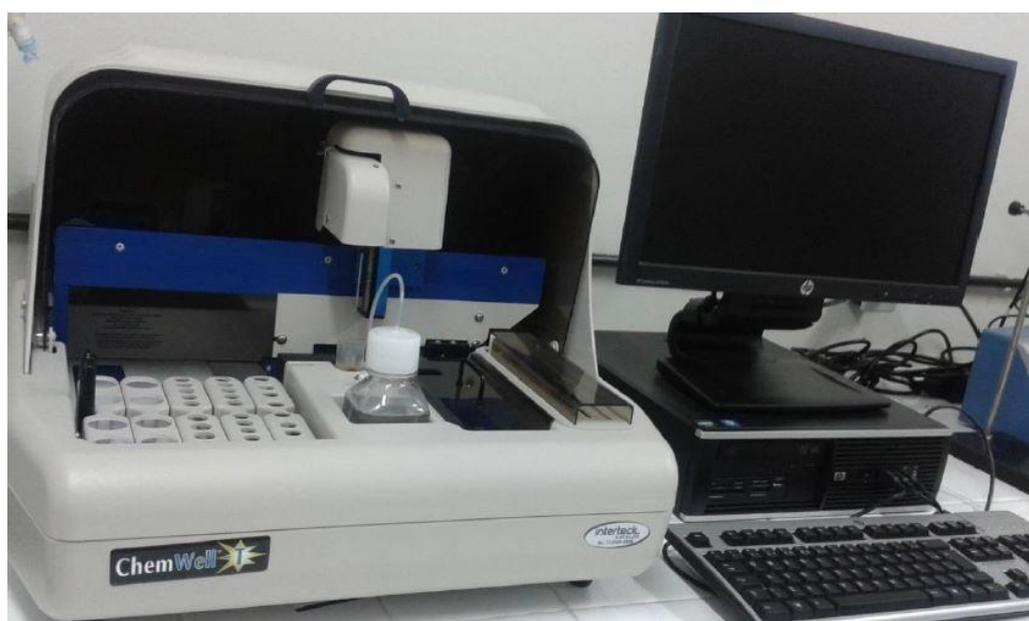
**Figura 5:** Aparato utilizado para as análises com espectrofotometria.
