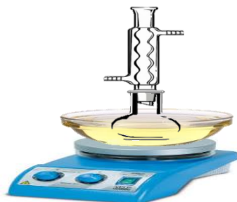
Figura 27. Representação esquemática do sistema para a reação de cetalização.
