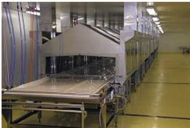
Figura 6 - Equipamento industrial do refractance window .
