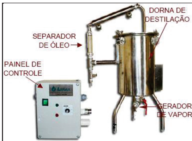
Figura 6 - Mini destilador de óleos essenciais – Linax (Modelo D2 – v5.2 – Linax)
