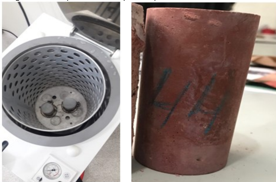
Figura 44 - Aspecto dos corpos de prova curados em autoclave.
