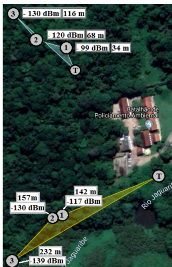
Figura 26 – Resultados dos testes de alcance e RSSI em ambiente florestal.
