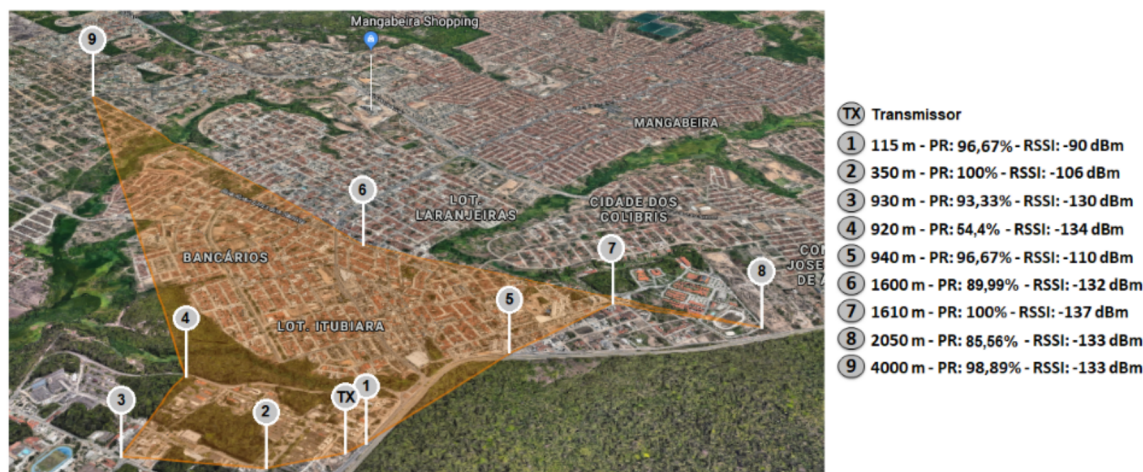
Figura 24 – Resultados dos testes de alcance e RSSI em ambiente urbano denso.
