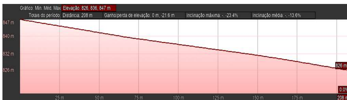
Figura 08: Dados de Declividade da Rua Manoel Clemente.
