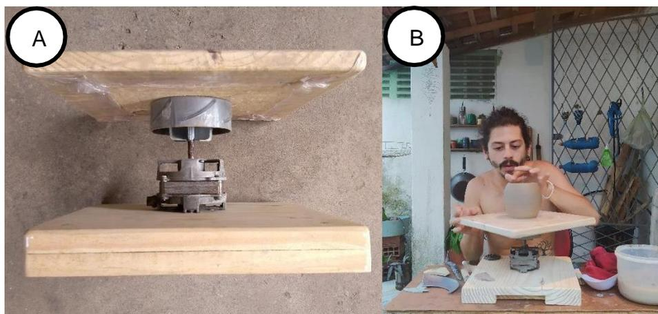
FIGURA 37: O torno manual de bancada, 2020. A) Visão lateral do torno, mostrando o motor avariado do ventilador utilizado. B) Modelando um vaso nesse torno. Fotografia Geraldo M.
