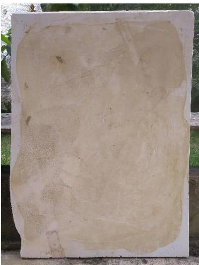
FIGURA 34: Placa de gesso para a secagem da argila líquida, 2020. Fotografia Geraldo M.
