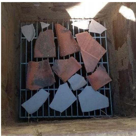
FIGURA 62: Preparação do forno para a queima, com cacos de terracota e restos de azulejos colocados sobre a grelha, 2020. Fotografia Geraldo M.
