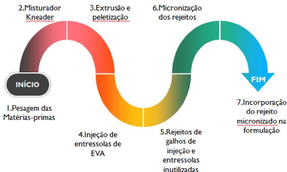
Figura 18 Processo proposto com a inclusão do processo de micronização.
