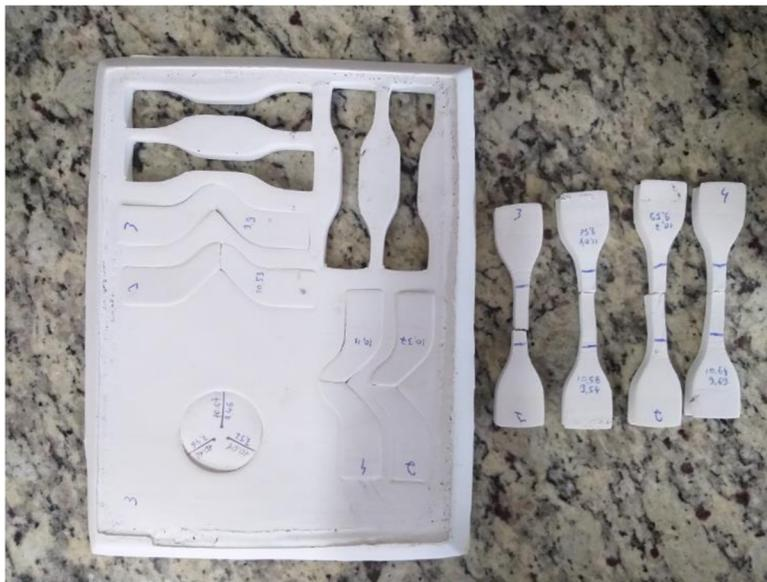
Figura 19 Placa obtida na prensa para os ensaios mecânicos
