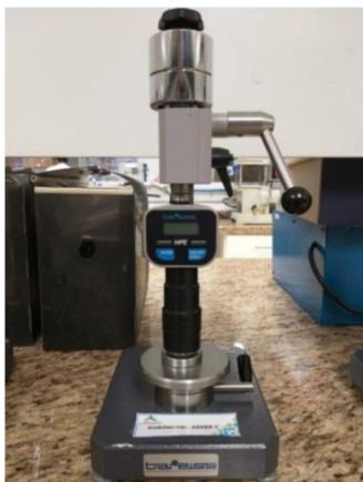
Figura 23. Durômetro ASKER C
