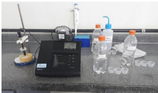
Figura 6 -Eletrodo íon específico para Flúor com potenciômetro acoplado.
