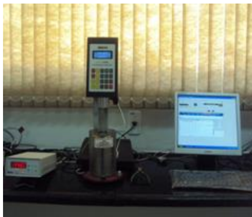
Figura 11: Ilustração do Viscosímetro Brookfield - Laboratório de Engenharia de Pavimentos LEP/DEC/UFCG. Fonte: Autoria Própria.
