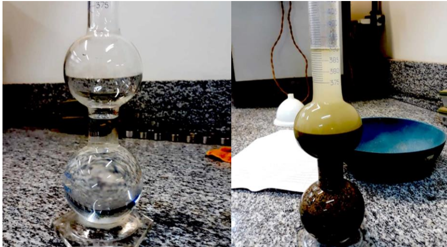
Figura 9: Determinação da massa específica por meio do Frasco Chapman . Fonte: Autoria Própria.
