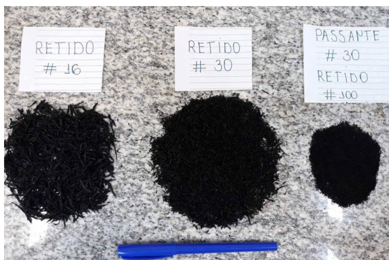
Figura 7: Borracha triturada de pneus inservíveis em diferentes granulometrias. Fonte: Autoria Própria.
