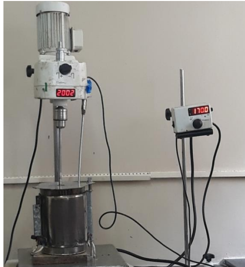
Figura 10: Miturador mecânico FISATOM, modelo 72 do LEP. Fonte: Autoria Própria.
