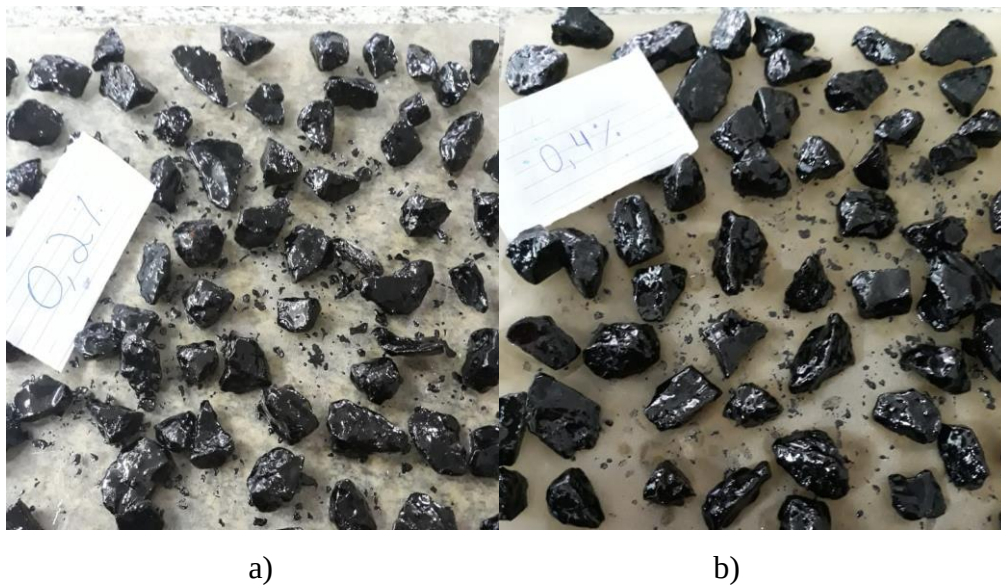
Figura 20: Resultados obtidos para o ensaio com a utilização do melhorador de adesividade em dois teores a) 0,2% e b) 0,4%. Fonte: Autoria Própria.
