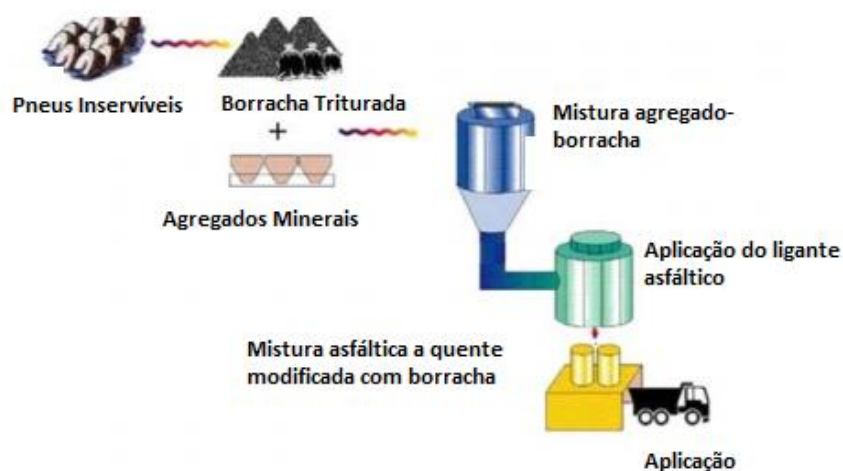
Figura 3: Etapas do Processo Seco. Fonte: Adaptado de NETO et al. (2006).
