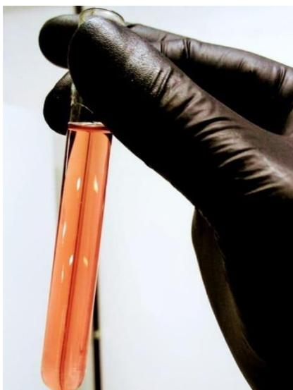
Dessa forma, para a construção da curva analítica, foram utilizadas soluções sintéticas de furfural com concentração de 0,1 % e pH de 4,3 em álcool etílico 50%. Tais condições foram utilizadas para simular as condições do licor pré-hidrolisado.
