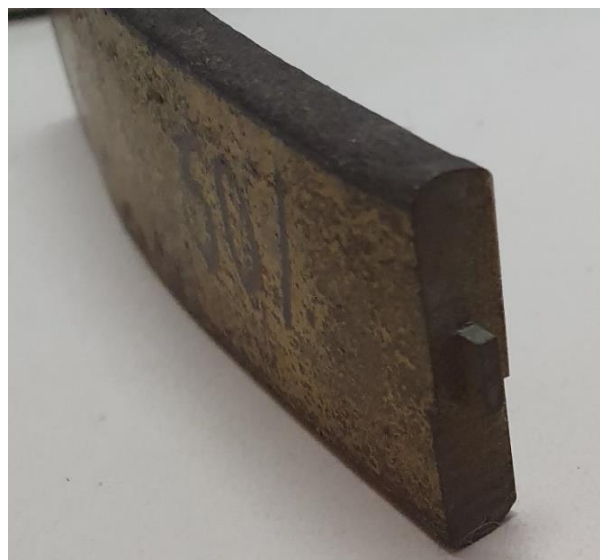
Figura 3.5 Resultado da laminação da amostra com redução de 50%
