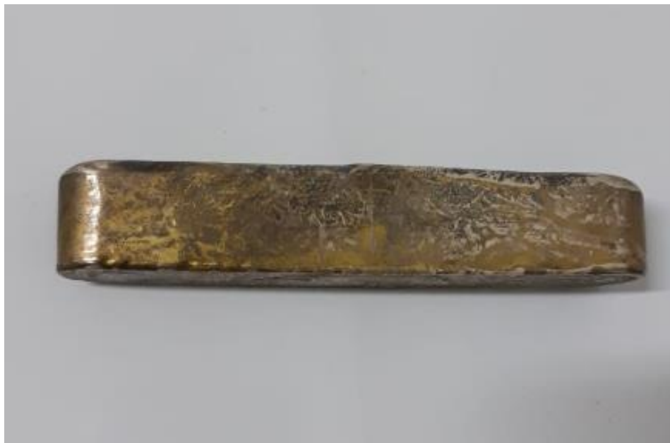
Figura 3.2 Lingote da liga Cu-11,8Al-0,55Be-0,5Nb-0,27 (% peso)
