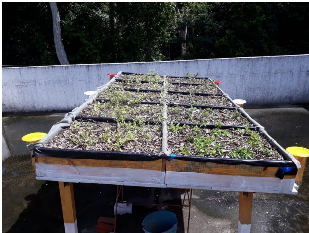
Figura 3: Protótipo de telhado verde e suas unidades. A esquerda plantada a espécie Richardia grandiflora e a direita Tridax procumbens . Nas laterais as armadilhas de prato ( pan traps ) nas cores amarelo, branco e vermelho.
