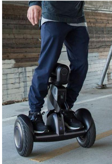
Figura 3.2 Segway com guidão entre os joelhos
