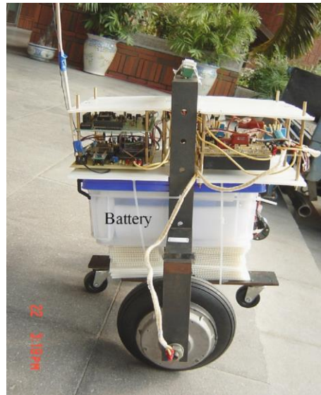
Figura 2.8 – Pêndulo invertido de duas rodas com PID auto ajustável Fonte: REN et al. (2008)
