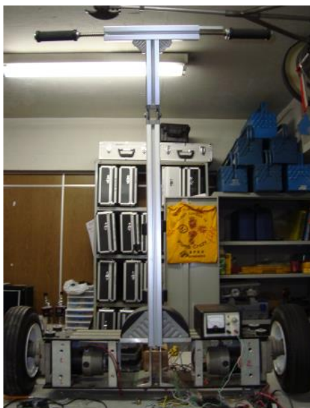
Figura 2.12 – Transportador Pessoal Robótico auto-equilibrante Fonte: MAMANI, 2010
