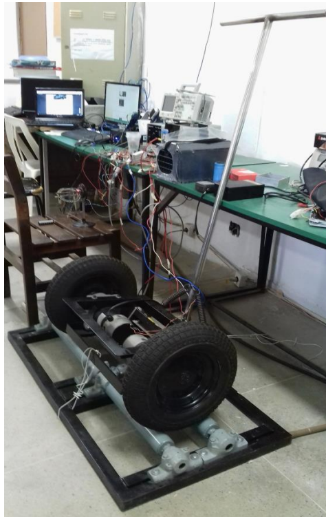
Figura 2.16 – Veículo elétrico controlado por lógica fuzzy Fonte: ANJOS, 2017
