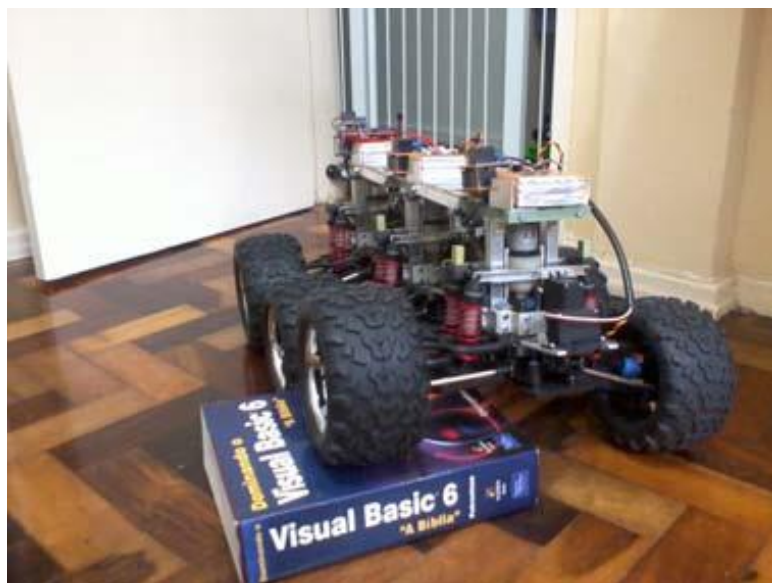
Figura 2.13 – Sistema robótico operado remotamente com Lógica Fuzzy Fonte: SILVEIRA, 2012
