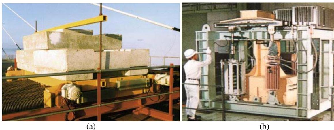
Figura 17 – Aplicação de sistema de controle passivo do tipo AMS. (a) Aplicação de AMS em ponte estaiada, na Normandia, França; (b) AMS utilizado na ponte de Akashi Kaikyo, no Japão. Fonte: Caetano (2007) e Kitagawa (2004).
