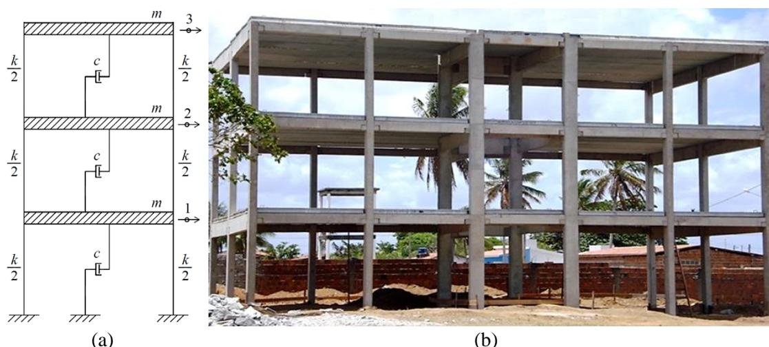
Figura 57 – Sistemas estruturais de 3GDL. (a) Modelo físico do pórtico; (b) Estrutura de pré-moldados de concreto com três pavimentos. Fonte: Adaptado de Moutinho (2007) e Central Premoldados Ltda. (2017).
