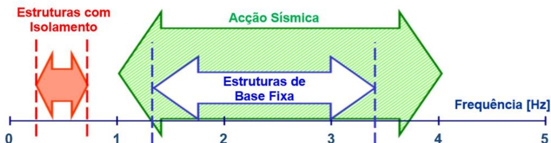
Figura 28 – Faixa de frequências típicas de abalos sísmicos com alta energia vibracional em comparação com sistemas sem/com isolamento de base. Fonte: Guerreiro, 2006.
