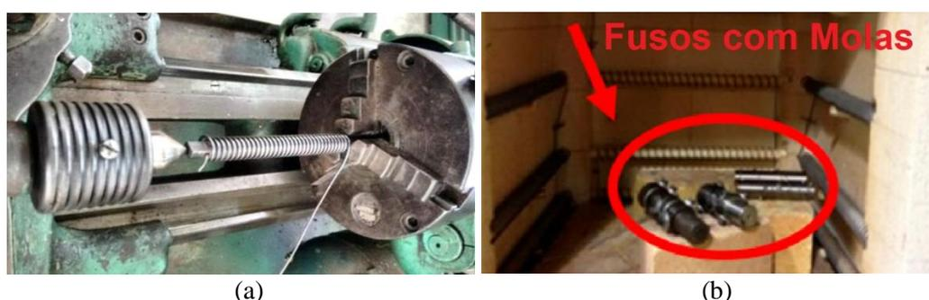
Figura 41 – Processo de fabricação de molas helicoidais LMF. (a) Conformação com uso de fuso e torno mecânico; (b) Aplicação de forno em tratamento térmico para *shape setting*. Fonte: Adaptado de Oliveira (2017) e Liu *et al.* (2019).
