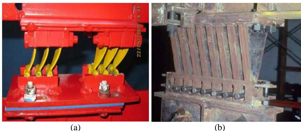
Figura 23 – Dissipadores passivos hysteréticos. (a) Amortecedores de placas triangulares de baixa espessura.; (b) Amortecedores de placas triangulares de alta espessura. Fonte: Li *et al.* (2014) e Scholl (1990).
