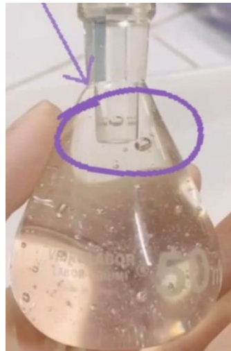
Figura 10: Dificuldade encontrada na análise de picnometria para géis.
