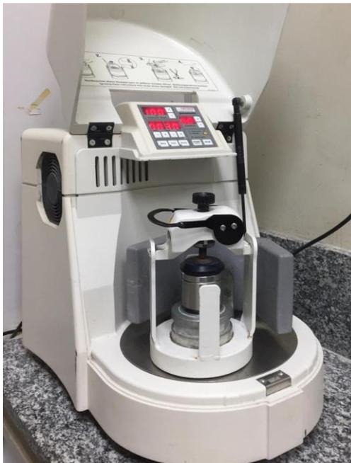
Figura 3.3 – Cadinho acoplado pronto para moagem no moinho planetário de bolas utilizado
