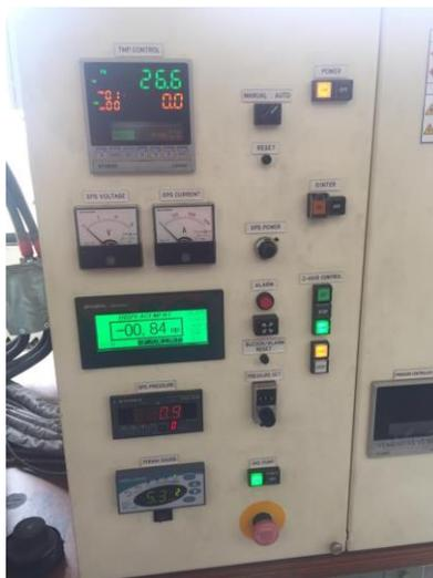
Figura 3.4 – Equipamento de SPS pronto para iniciar sinterização.
