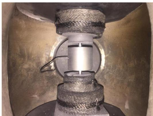
Figura 3.6 – Matriz preparada para sinterização com termopar conectado.
