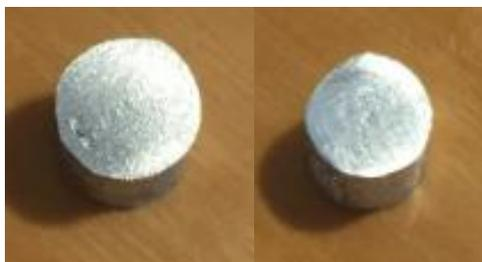
Figura 4.8 – Compósitos sinterizados via SPS.
