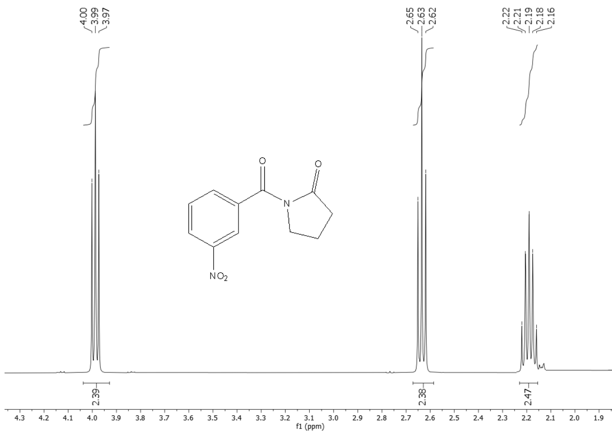
Espectro 598: Expansão do espectro de RMN de 1 H (500 MHz, CDCl 3 ) da 1-(3-nitrobenzoyl)pirrolidin-2-ona (14).
