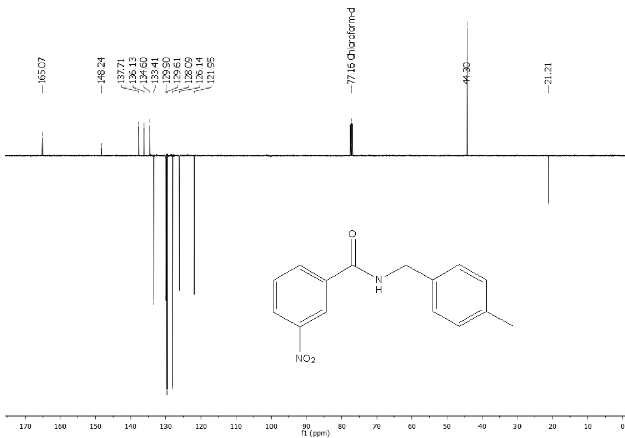
Espectro 26: Espectro de RMN de ^{13}\text{C} -APT (100 MHz, \text{CDCl}_3 ) da N -(4-metilbenzil)-3-nitrobenzamida (06).
