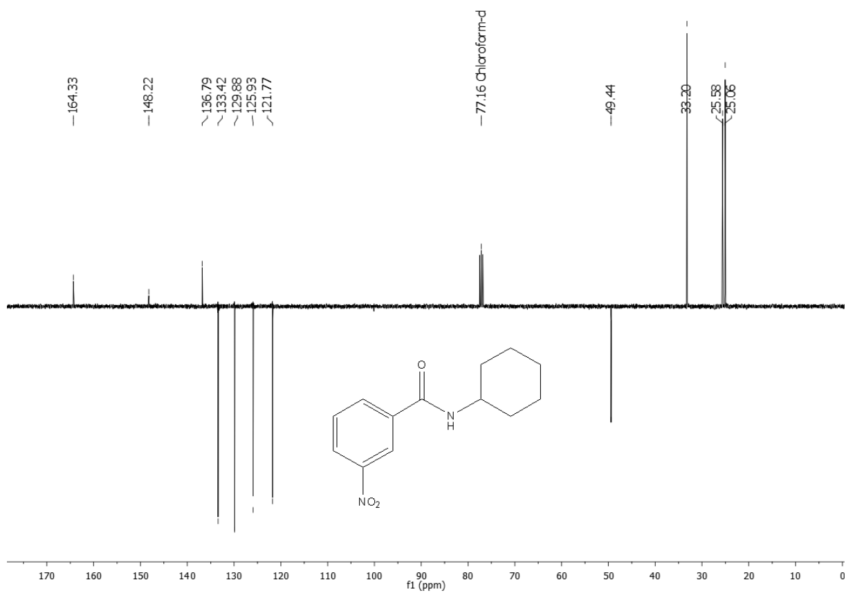
Espectro 55: Espectro de RMN de ^{13}\text{C} -APT (100 MHz, CDCl 3 ) da N -ciclohexil-3-nitrobenzamida (13).
