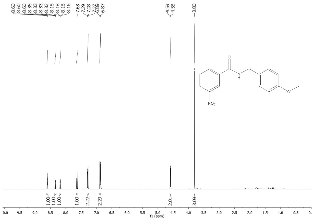
Espectro 28: Espectro de RMN de 1 H (500 MHz, CDCl 3 ) da N -(4-metoxibenzil)-3-nitrobenzamida (07).
