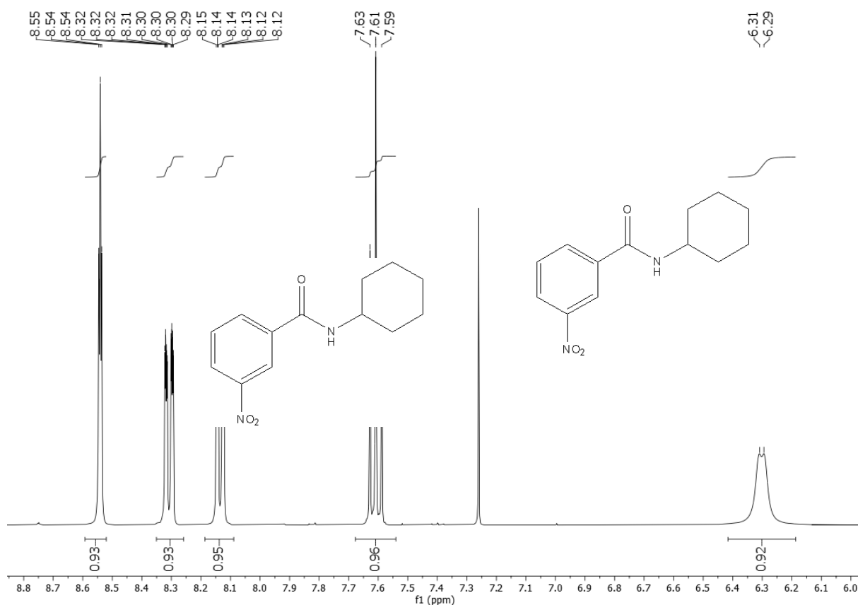
Espectro 53: Expansão do espectro de RMN de 1 H (400 MHz, CDCl 3 ) da N -ciclohexil-3-nitrobenzamida (13).
