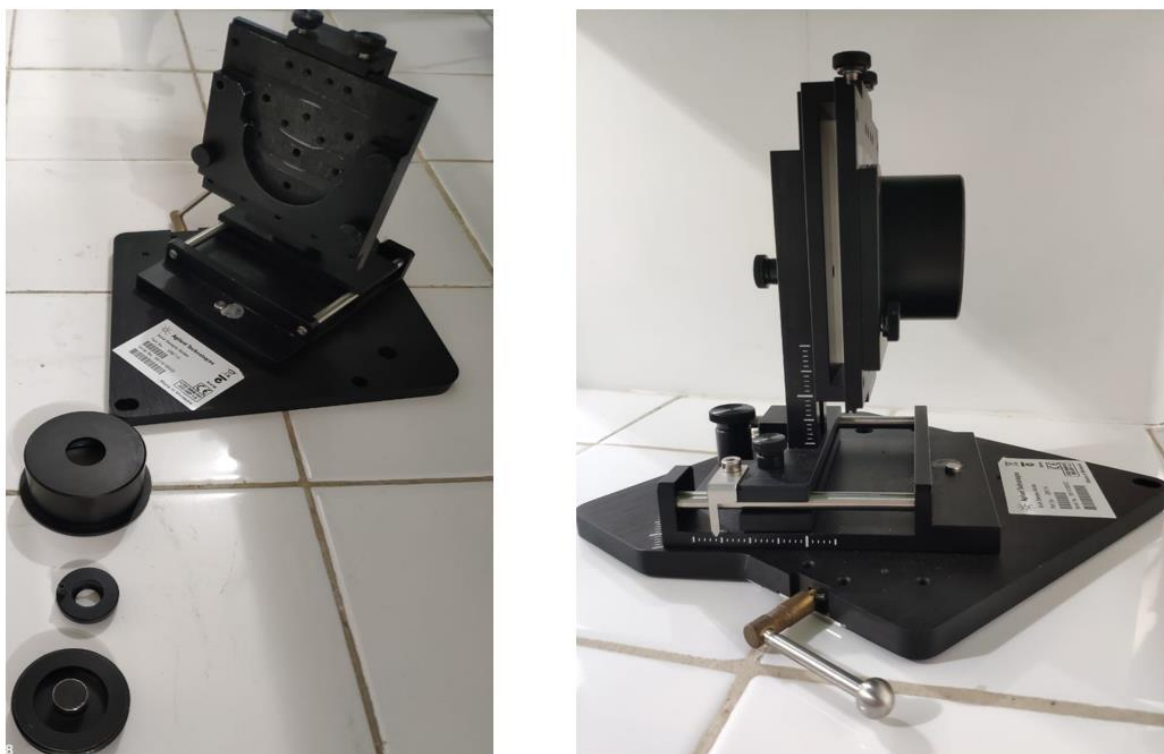
Figura 3. Parafusos e ajustes para ângulo, altura e posição para melhor detecção da amostra.
