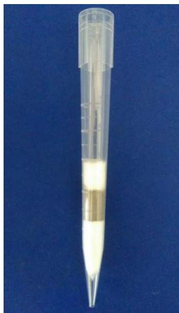
Figura 7. Coluna para extração de solos utilizando lã de vidro e ponteira de 5 mL.
