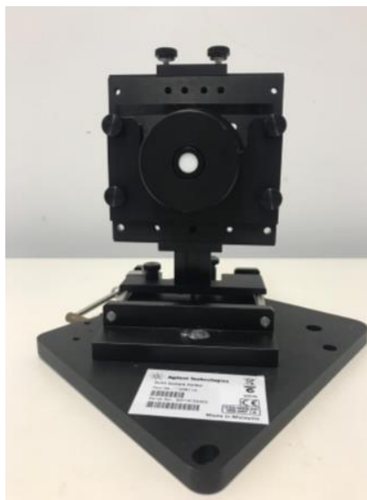
Figura 9. Suporte para sólidos do espectrofluorímetro com a membrana de náilon.
