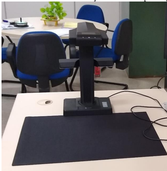
Figura 4: Scanner Planetário em Estação de trabalho para digitalização
